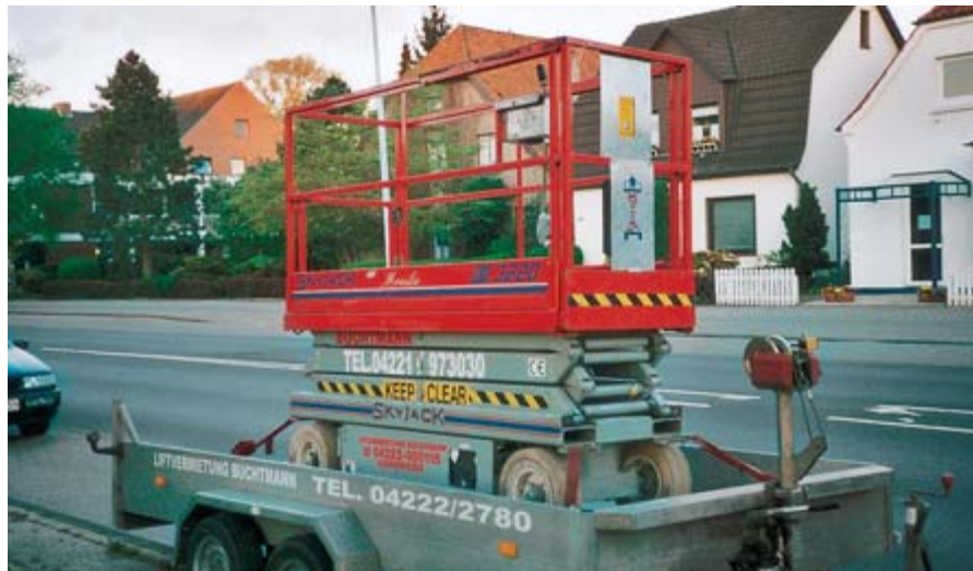
Dieses Gerät wurde durch Diagonalzurren mit vier Zurrurten ausreichend gesichert.
