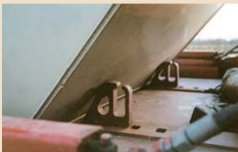
◀ Formschlüssige Sicherung eines Absetzbehälters in Fahrtrichtung.
