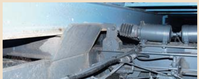
▲ Blick unter einen Abrollbehälter, der durch Halteeinrichtung ausreichend gesichert wird.
