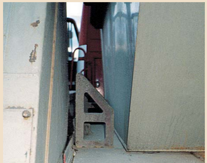
▲ Formschlüssige Sicherung eines Absetzbehälters zur Seite. Der Abstand zur Halteeinrichtung ist nur gering und kann akzeptiert werden.
