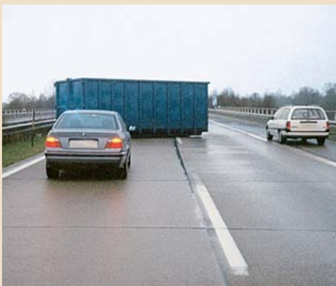
▲ Während der Fahrt fiel dieser Abrollbehälter von der Lade- fläche.
