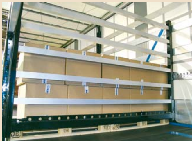
▲ Mit dieser Konstruktion kann eine Ladung über die gesamte Breite der Ladefläche in Fahrtrichtung blockiert werden.
