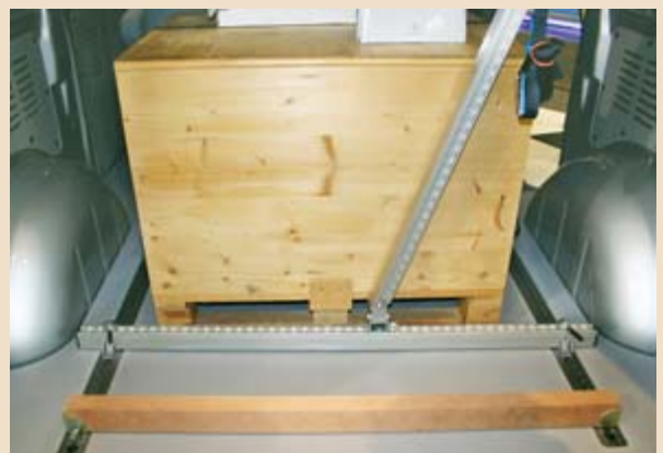
Hier werden verschiedene Arten von Ankerschienen gezeigt. In diesen Bauteilen können Sperrstangen mit ihren Bolzen fixiert werden. Diese Ankerschienen eignen sich auch für eine Nachrüstung.
