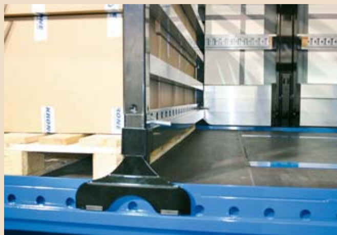
▲ Diese Lösung ist als Stecksystem gefertigt und basiert auf einem Multiblock, der im Außenlochrahmen des Fahrzeugs verankert wird.
