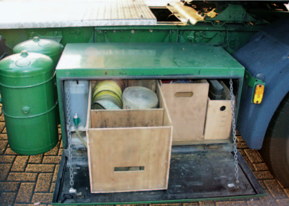
◀ Staukasten an einer Sattelzugmaschine mit passend gefertigten Holzkästen.
