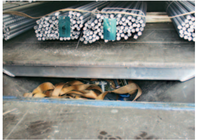
▲ Auch das ist keine Lösung, denn die Zurrgurte sind nach der Beladung nicht mehr erreichbar.
