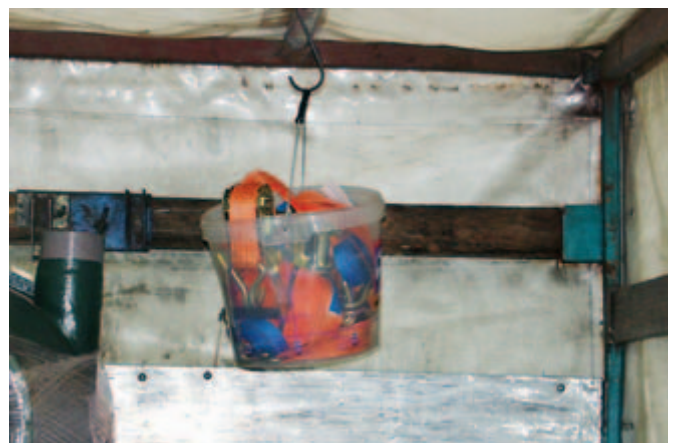
▲ Originelle Lösung: Eimer mit Zurrmitteln in einem 7,49 Tonner.
