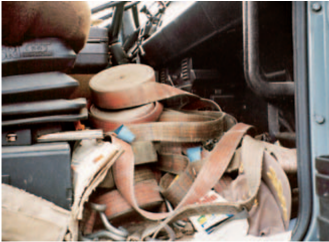
▲ Das ist unzumutbar: Die Zurrgurte gehören in einen Staukasten.
