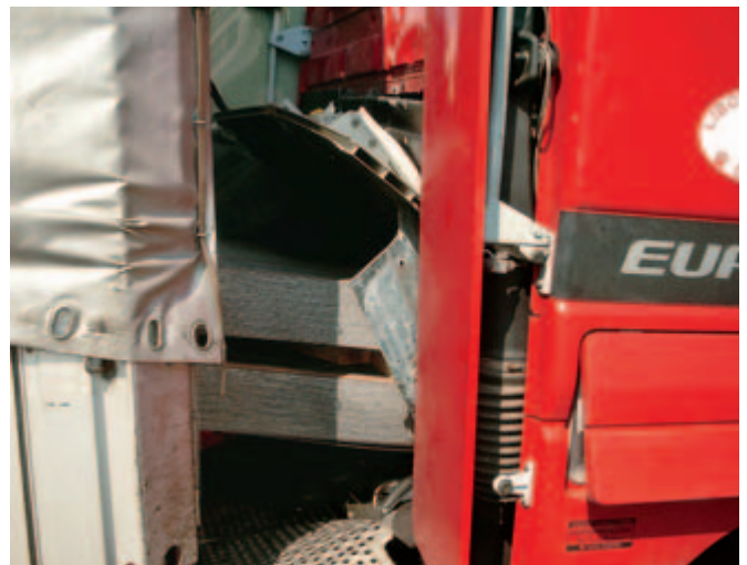
Die Blechpakete haben die Stirnwand durchschlagen und das Fahrerhaus beschädigt.
