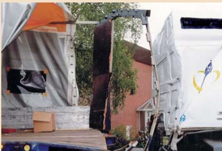
▲ Die Stirnwand des Sattelanhängers wurde herausgeschlagen.
