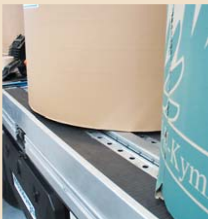
▲ Auf Jolodarollern stehend werden die Rollen automatisch in das Fahrzeug geschoben.
