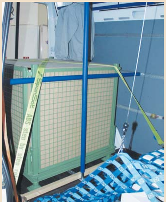
▲ Ladungssicherung in Fahrtrichtung durch einen Holzbalken, zwei Sperrbalken und zwei Zurrgurte.
