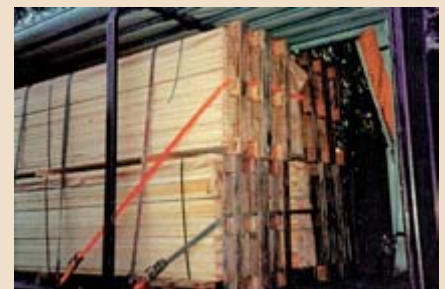
▲ Formschluss nach vorn durch Kopfschlingen.
