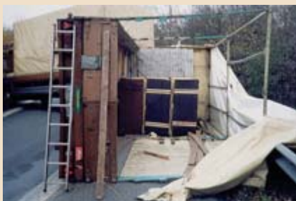
▲ Die Ladung war unter Missachtung der Lastverteilung direkt an die Stirnwand geladen.
