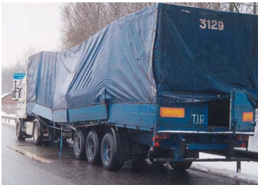
Beim Herausrutschen der Ladung wurde der Fahrzeugaufbau massiv beschädigt.
