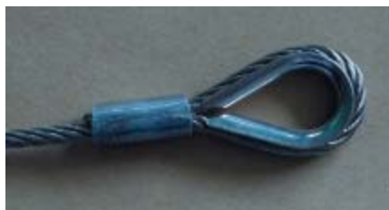
Korrekte Seilendverbindung mit Pressklemme und Kausche.
