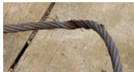
Dieses Zurrdrabtseil ist zu stark gequetscht.
