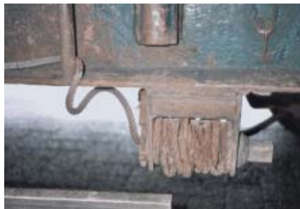
Dieses Zurrdrabtseil und die Wickelwelle sind wegen der Witterungseinflüsse stark verrostet.
