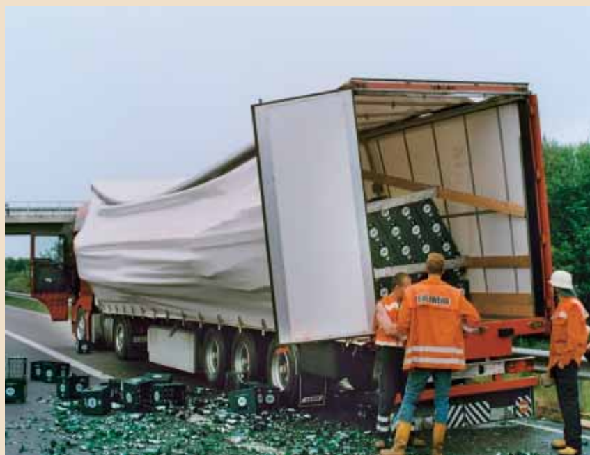
▲ Ein Standard-Curtainsider ist nicht in der Lage, diese Ladung mit seinem Aufbau zu sichern.
