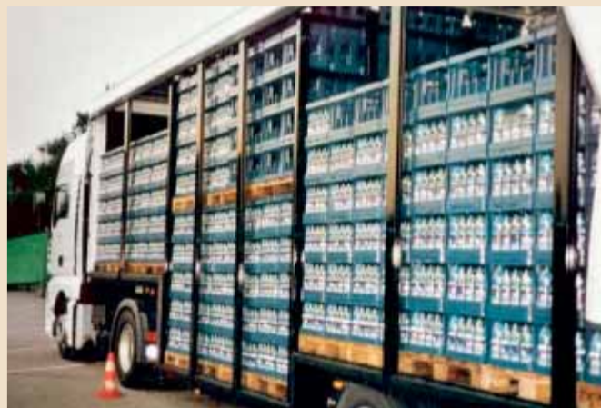
▼ Dieser verstärkte Aufbau ist in der Lage, die Ladung ausreichend zu sichern.
