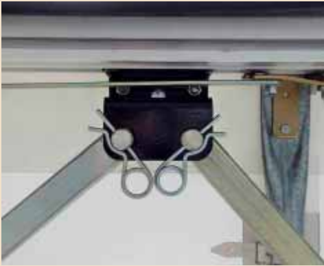
◀ Die Stangen können zum Öffnen des Daches entfernt werden.
