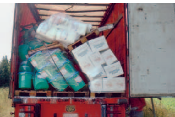
Die Sicherung der Ladegüter auf der Palette und die Ladungssicherung auf dem Fahrzeug waren so schlecht, dass die Ladung weitgehend unbrauchbar wurde.
