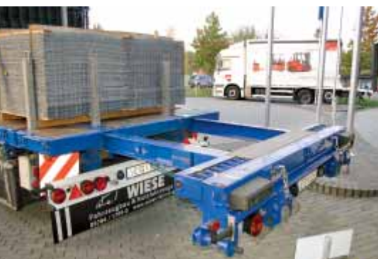
Die rückwärtigen Rungen können der Ladung formschlüssig angepasst werden.
