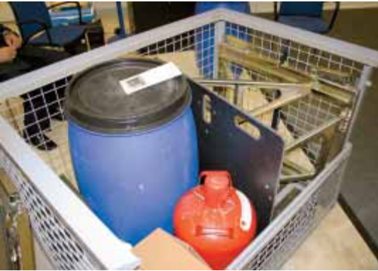
Die Ladelücke in der Gitterbox wird ausgefüllt und die Ladung dadurch formschlüssig gesichert.
