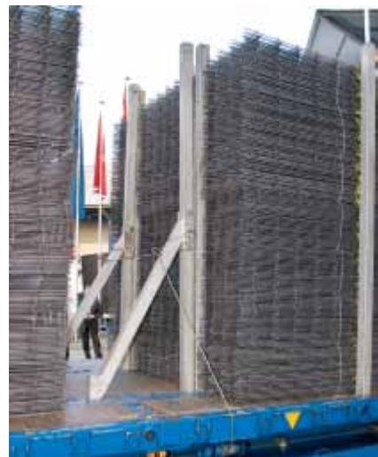
Die Matten werden seitlich und in Fahrtrichtung durch Einsteckungen gesichert.
