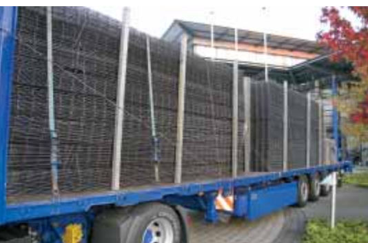
Fahrzeug mit Spezialausstattung für den Transport von Baustahlmatten
