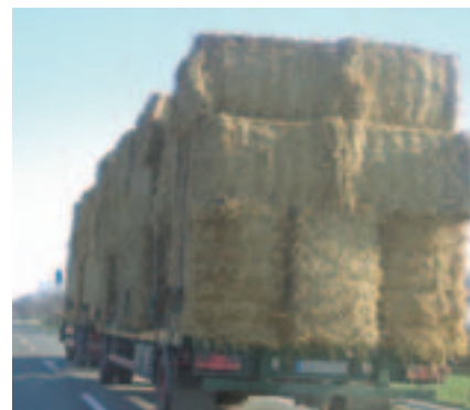
Strohballen haben einen recht hohen Reibbeiwert, trotzdem sind sie ausreichend zu sichern.
