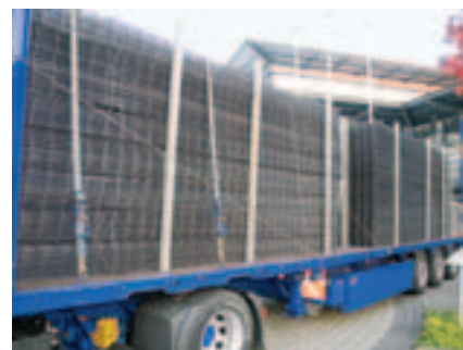
Baustahlmatten sind glatt. Sie sind am besten durch Rungen zu sichern.
