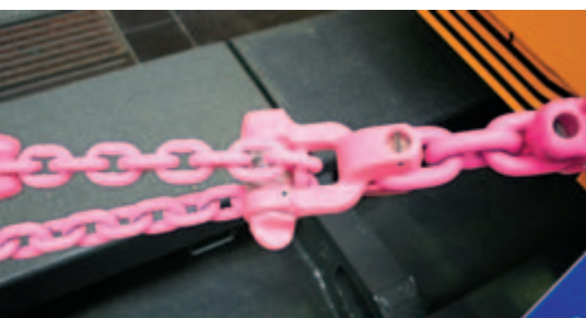
Die Umlenkrolle gleicht Spannungsunterschiede aus.
