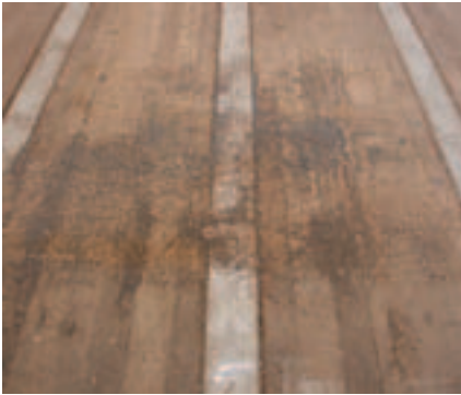
Der Schmutz auf der Ladefläche wirkt wie ein Kugellager unter der Ladung.
