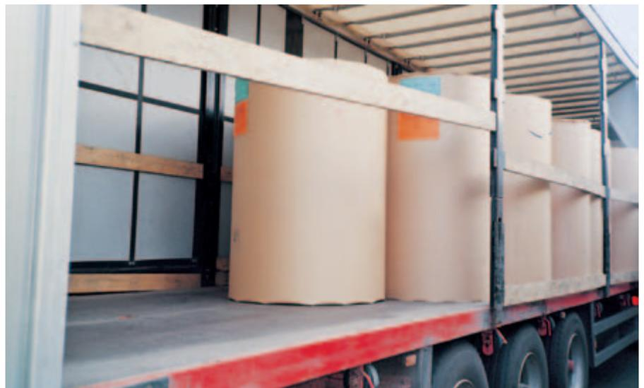
Die Rollen gerieten beim Bremsen ins Rutschen. Hätte das Fahrzeug noch ausweichen müssen, hätten sie den Aufbau zerstört und wären seitlich von der Ladefläche gerutscht.
