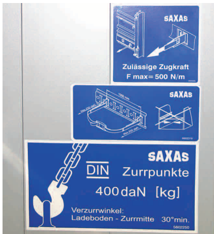
Kennzeichnung im Fahrzeugaufbau eines Kastenwagens mit einem Hinweis auf die DIN-Norm (Beispiel)
