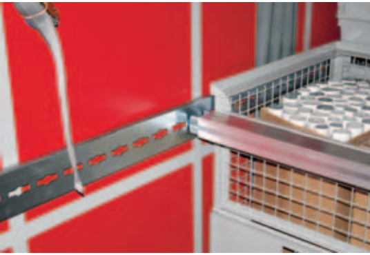
Sperrbalken werden in Ankerschienen eingerastet.
