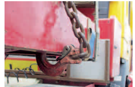
Der Haken und die Kette werden auf Biegung beansprucht. Hier ist unbedingt ein geeigneter Zurrpunkt erforderlich.
