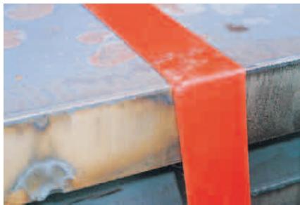
Es ist nur eine Frage der Zeit, bis dieser Zurrgurt an der scharfen Kante durchgescheuert wird.
