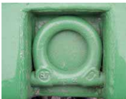
Besonders gekennzeichnete Zurrpunkt auf einem Schwertransportfahrzeug.
