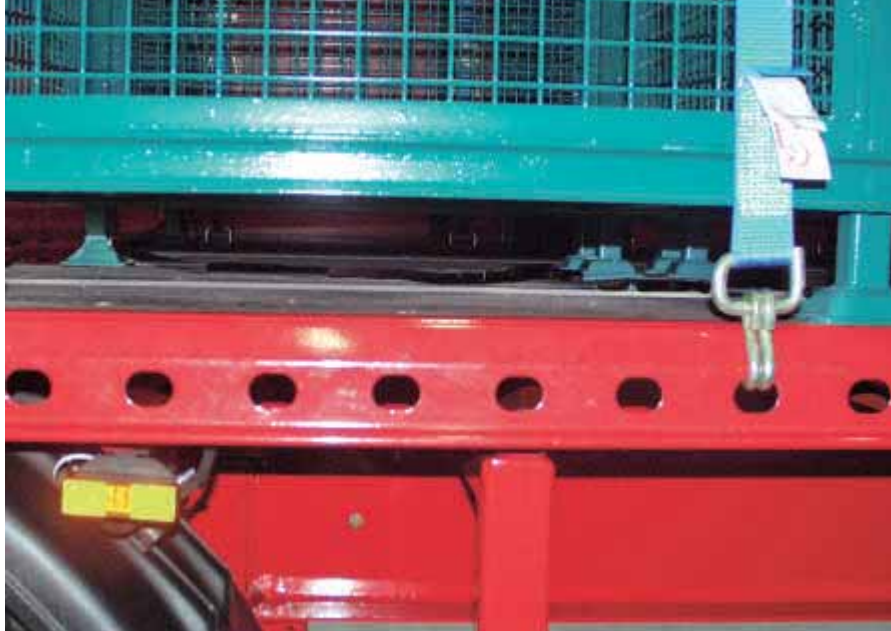
Jedes dieser Löcher im Außenrahmen kann als Zurrpunkt genutzt werden.
