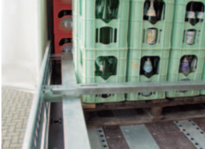
Ladungssicherung durch Blockieren mit ausreichend belastbaren Sperrbalken
