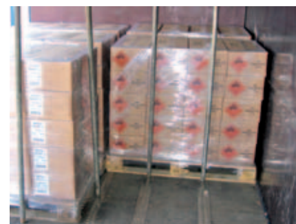
Sperrstangen zur rückwärtigen Ladungssicherung in einem Kofferverfahrzeug
