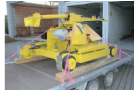
Sicherung durch Diagonalzurren (Foto RUD)
