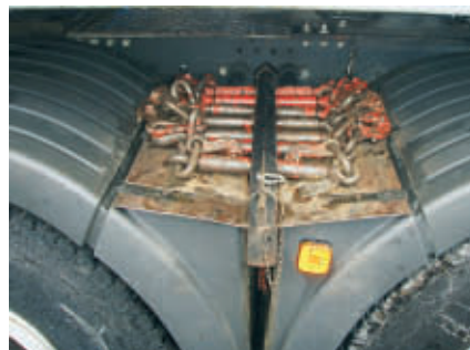
Unverlierbar: Die Kettenspanner sind durch einen Bügel gesichert.
