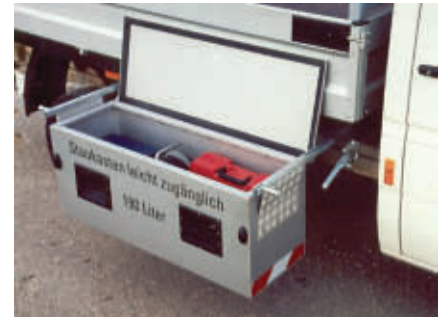
Innovativ: Seitlich ausziehbarer Staukasten. Foto: Fa. Klingler
